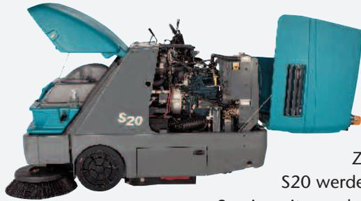
**Reduzierte Ausfallzeiten, Servicezeiten und Wartungskosten,** Durch den einfachen und werkzeuglosen Zugang zum "Herz" der S20 werden Ausfall- und Servicezeiten reduziert und Wartungskosten verringert.
