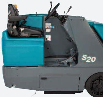
**Der komfortable Bedienerplatz** beinhaltet einen verstellbaren Sitz und ein verstellbares Fahrpedal, sowie ein verstellbares Lenkrad. Wichtige Sicherheitsfunktionen beinhalten ausgezeichnete Rundumsicht des Bedieners, freie Sicht auf den Seitenbesen, einfache Bedienung, Kontrollleuchte für Parkbremse und vieles mehr.
